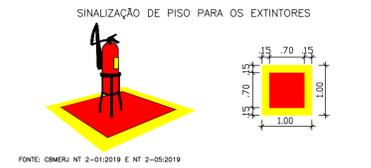
3 DETALHE - INSTALAÇÃO E SINALIZAÇÃO DE EXTINTORES S/ ESCALA
