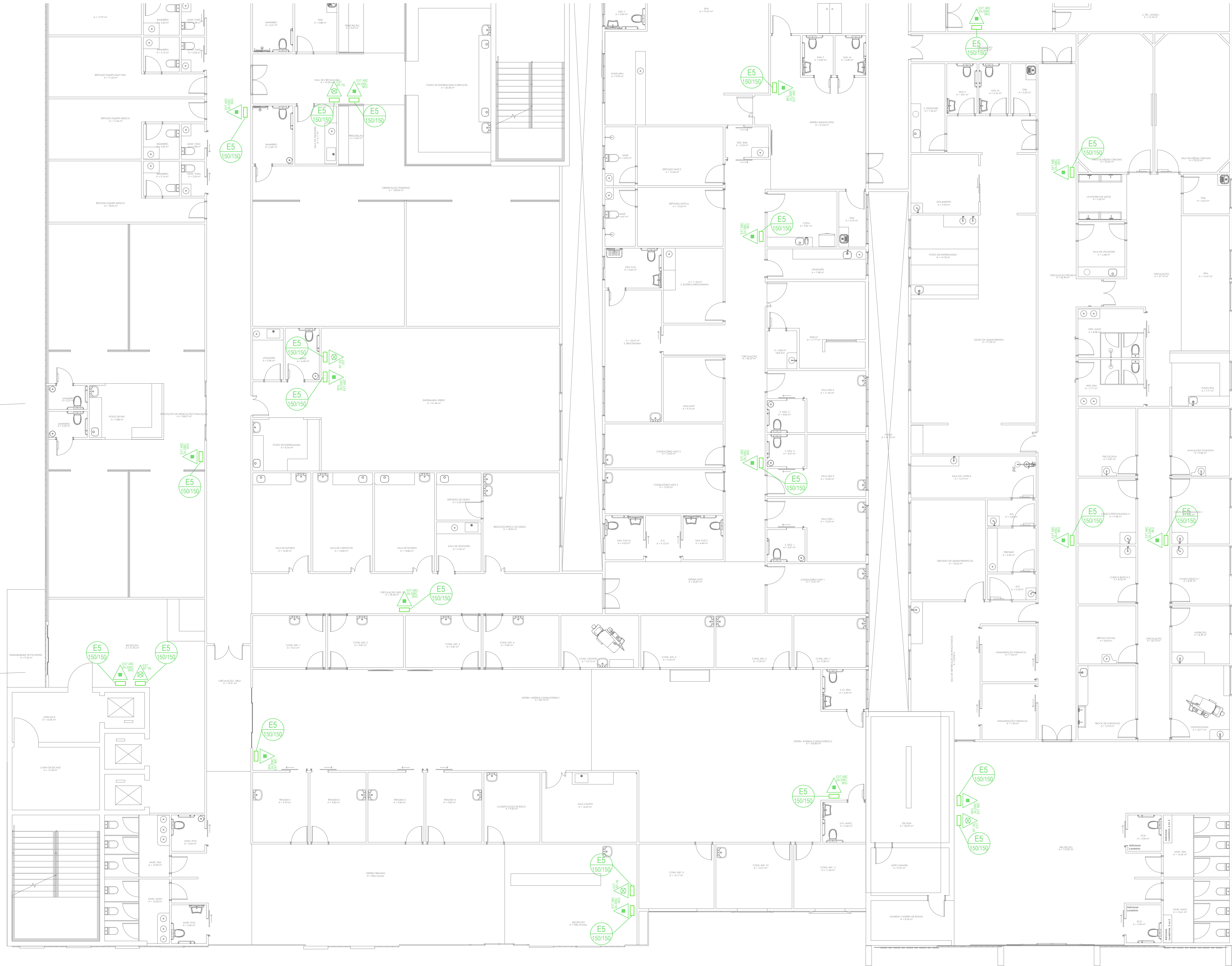
01 PROJETO DE EXTINTORES - TÉRREO - PARTE 02 ESC.: 1/100
