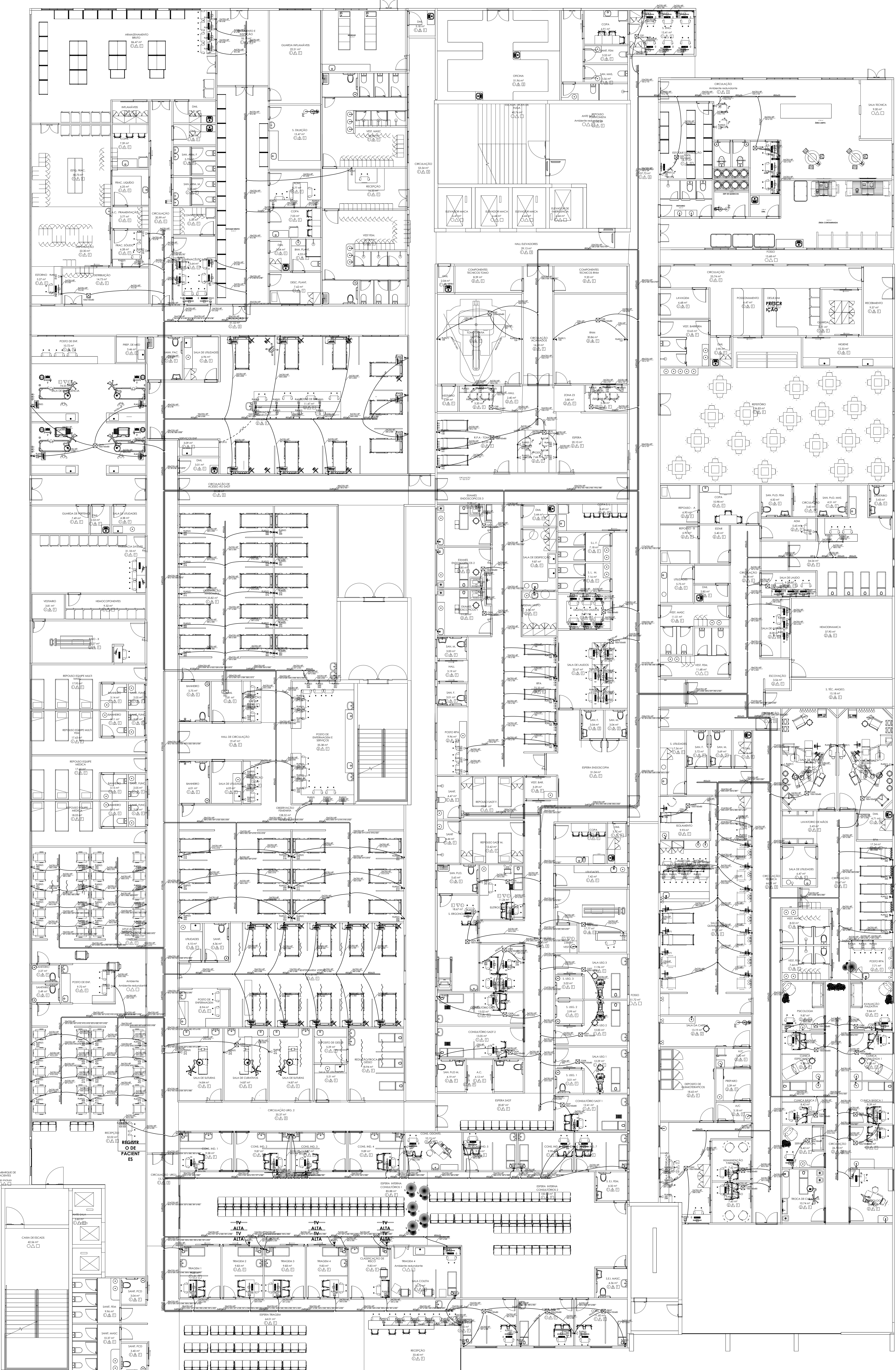
PLANTA DE DISTRIBUIÇÃO DO CABEAMENTO ESTRUTURADO (TÉRREO) ESCALA 1 : 100
