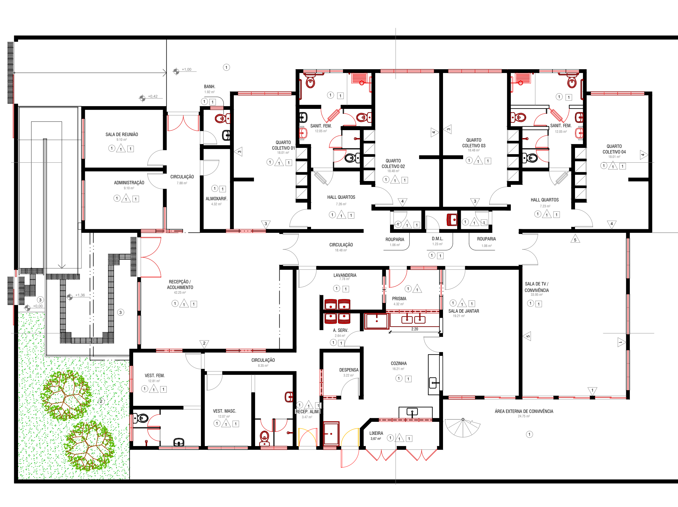
QUADRO DE ÁREAS ÁREA TOTAL DO TERRENO 600,00m2 ÁREA TOTAL CONSTRUÍDA 365,13m2 TAXA DE OCUPAÇÃO 60,85% LEGENDA PISO 1 - EXISTENTE; 2 - GRAMA ESMERALDA; 3 - PISO EM GRANITO COM TRATAMENTO SERRADO OU JATEADO, PLACAS DE 40x40cm; 4 - PISO CIMENTADO LISO. PAREDE 1 - PINTURA ACRÍLICA SUIVINIL ACRÍLICO LAVÁVEL, COR GELEIRA INFINITA 2 - PINTURA ACRÍLICA COR JASMIN AMARELO C293 OU SIMILAR 3 - PINTURA ACRÍLICA COR LIBERDADE AZUL, RS20 OU SIMILAR; 4 - PINTURA ACRÍLICA COR BABOSA E056 OU SIMILAR; 5 - PINTURA ACRÍLICA COR CEREJEIRA C404 OU SIMILAR; TETO 1 - PINTURA ACRÍLICA NA COR BRANCO NEVE, SOB FORRO DE GESSO QUADRO DE ESQUADRIAS PORTAS LEG DIMENSÕES OBSERVAÇÕES P1 55X175 cm PORTA DE ABRIR EM LAMBRI DE ALUMÍNIO, 01 FOLHA, COR NATURAL. P2 80X210 cm PORTA DE ABRIR EM LAMBRI DE ALUMÍNIO, 01 FOLHA, COR BRANCA. P3 90X210 cm PORTA DE ABRIR DE MADEIRA COM PINTURA ESMALTE SINTÉTICO COR BRANCA, COM CHAPA DE ALUMÍNIO (H=40 cm), GUARN. EM FREJO C/ PINTURA ESMALTE COR BRANCO - SUIVINIL + BARRA CROMADA P4 160X210 cm PORTÃO DE CORRER EM GRADIL, METÁLICO NA BRANCA COM REQUADRO EM ALUMÍNIO E 0,30CM FIXO. P5 140X210 cm PORTA DE CORRER EM ALUMÍNIO E VIDRO TEMPERADO 10MM c/ PINT. ELETROSTÁTICA COR BRANCO, 2 FOLHAS P6 140X210 cm PORTA DE ABRIR EM VENEZIANA DE ALUMÍNIO NATURAL, 2 FOLHAS. P7 180x210 cm PORTA DE ABRIR EM VIDRO TEMPERADO INCOLOR 10MM (2 FOLHAS) COM PELÍCULA DE SEGURANÇA. P8 280X250 cm PORTÃO DE CORRER GRADIL, METÁLICO NA COR BRANCA COM REQUADRO EM ALUMÍNIO, 1 FOLHA. JANELAS J1 80X60 cm (HP = 150 cm) JANELA TIPO MAXIMAR EM ALUMÍNIO NATURAL E VIDRO LISO (COLOCAÇÃO DE TELA MOSQUITEIRO EM ÁREAS DE COZINHA, RECEP. DE ALIM., DESPENSA E SERVIÇO) J2 60X120 cm (HP = 90 cm) JANELA TIPO MAXIMAR EM ALUMÍNIO NATURAL E VIDRO LISO (COLOCAÇÃO DE TELA MOSQUITEIRO EM ÁREAS DE COZINHA, RECEP. DE ALIM., DESPENSA E SERVIÇO) J3 120X60 cm (HP = 90 cm) JANELA TIPO MAXIMAR EM ALUMÍNIO NATURAL E VIDRO LISO (COLOCAÇÃO DE TELA MOSQUITEIRO EM ÁREAS DE COZINHA, RECEP. DE ALIM., DESPENSA E SERVIÇO) J4 120X60 cm (HP = 150 cm) JANELA TIPO MAXIMAR EM ALUMÍNIO NATURAL E VIDRO LISO (COLOCAÇÃO DE TELA MOSQUITEIRO EM ÁREAS DE COZINHA, RECEP. DE ALIM., DESPENSA E SERVIÇO) J5 120X60 cm (HP = 340 cm) JANELA TIPO FIXO COM VENTILAÇÃO PERMANENTE EM ALUMÍNIO NATURAL E VIDRO LISO (VIDE DETALHAMENTO EM PROJETO) J6 180X60 cm (HP = 340 cm) JANELA TIPO FIXO COM VENTILAÇÃO PERMANENTE EM ALUMÍNIO NATURAL E VIDRO LISO (VIDE DETALHAMENTO EM PROJETO) J7 240X60 cm (HP = 90 cm) JANELA TIPO MAXIMAR EM ALUMÍNIO NATURAL E VIDRO LISO J8 240X60 cm (HP = 150 cm) JANELA TIPO MAXIMAR EM ALUMÍNIO NATURAL E VIDRO LISO VISORES E VIDROS V1 100x120cm PAINEL FIXO EM VIDRO TEMPERADO INCOLOR 10mm. V2 100x120cm VIDRO TEMPERADO INCOLOR 10mm. V3 130x170cm PAINEL FIXO EM VIDRO TEMPERADO INCOLOR 10mm. V4 180x60cm VIDRO TEMPERADO INCOLOR 10mm. V5 120x60cm VIDRO TEMPERADO INCOLOR 10mm. OBSERVAÇÕES 1 TODOS OS BANHEIROS PCD DEVERÃO CONTER AS ESPECIFICAÇÕES DETALHADAS ACIMA NO DESENHO; 2 AS PORTAS DE TODOS OS COMPARTIMENTOS DEVERÃO CONTER A LOCALIZAÇÃO DA COMUNICAÇÃO VISUAL CONFORME DETALHAMENTO ACIMA, A BARRA DE APOIO DEVERÁ SER INSTALADA APENAS NOS BANHEIROS PCD, DO LADO OPÓSITO DO SENTIDO DE SUA ABERTURA; 3 O PISO TÁTIL DEVERÁ SEGUIR AS ESPECIFICAÇÕES DO PROJETO QUANTO A LOCALIZAÇÃO DE SUAS PEÇAS E A ESPECIFICAÇÃO DE MATERIAL E COLORAÇÃO ADEQUADA.
